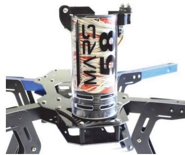
Fig. 12. 스프링 사출 방식 낙하산 발사대 형상
