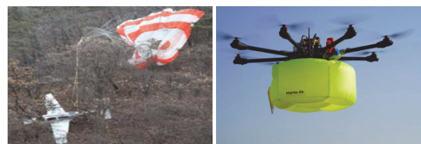
Fig. 4. 비상낙하산 전개 및 충격흡수 에어백 예시
