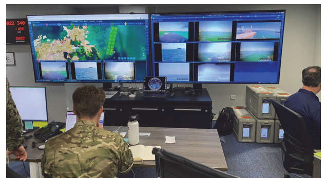
Fig. 2. TF 59 인원이 ROC(Robot Operation Center)에서 Starshield를 이용하여 무인전력과 정보교환 및 지휘통제하는 모습[13]
