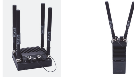
Fig. 3. Mesh network 관련 무선통신 장비(SILVUS)[15] (통신대역: 300 MHz - 6 GHz, 통신속도: 최대 100 Mbps)
